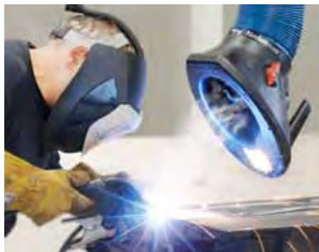
Extração de fumos com um braço extrator da Nederman
