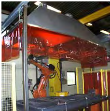
Sistema de exaustão com coifas para robôs
